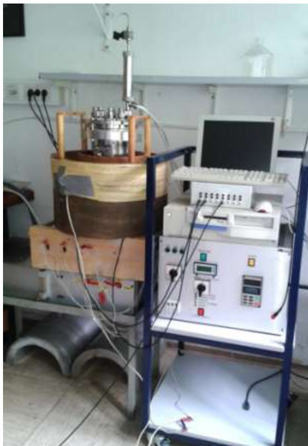
Slika 11: 10 L mešalni bioreaktor v magnetnem polju (Chemap AG, Švica)
