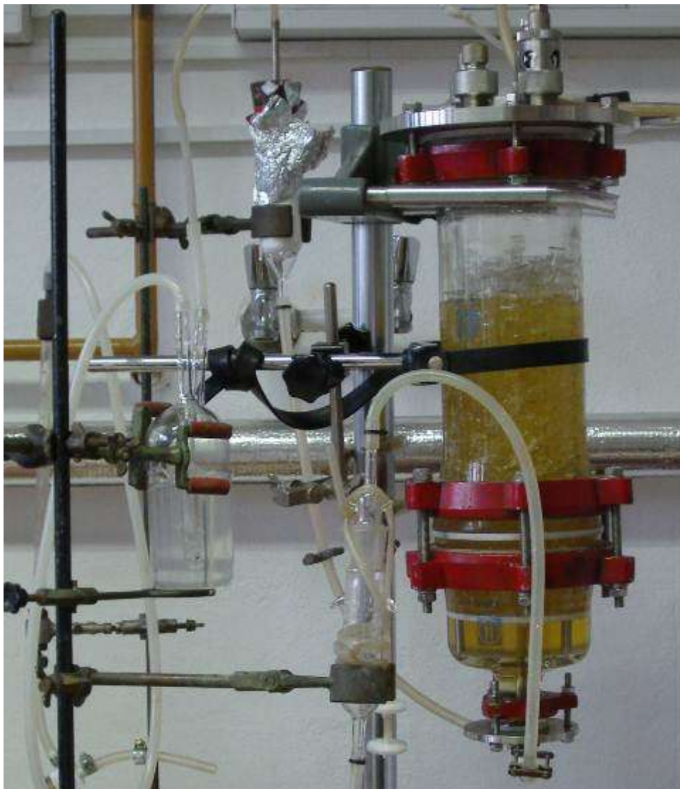
Slika 25: Laboratorijski bioreaktor za gojenje v tekočem gojišču na trdnih nosilcih (slikan brez zunanje grelne kače).
