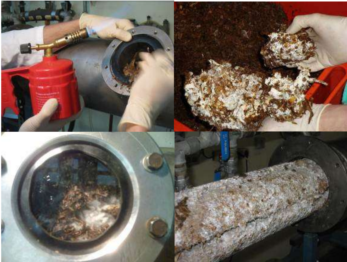
Slika 42: Gojenje v pilotnem mešalnem bioreaktorju.
