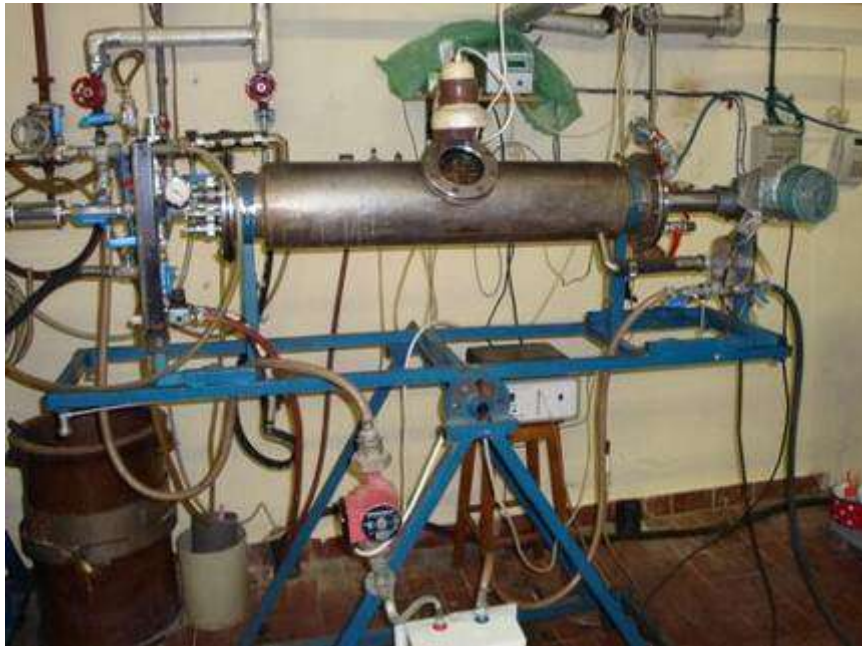
Slika 15: Pilotni mešalni bioreaktor - horizontalna pozicija.
