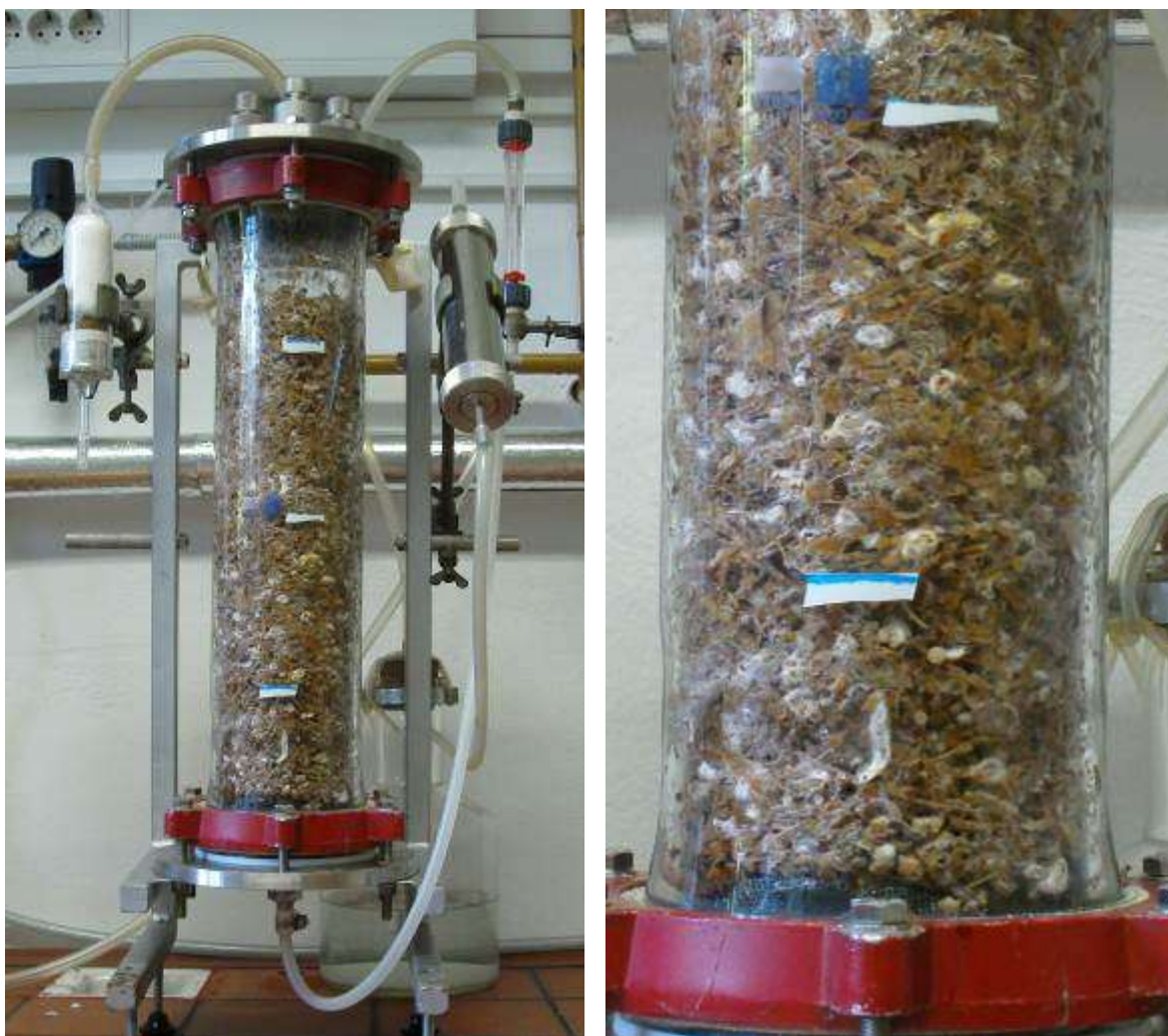
Slika 13: Laboratorijski bioreaktor za gojenje na trdnem gojišču (slikan brez zunanje grelne kače).
