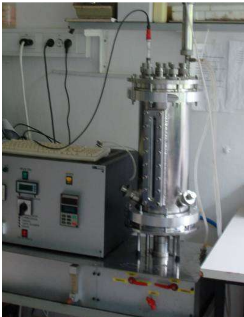
Slika 21: Mešalni bioreaktor z delovnim volumnom 18 L.
