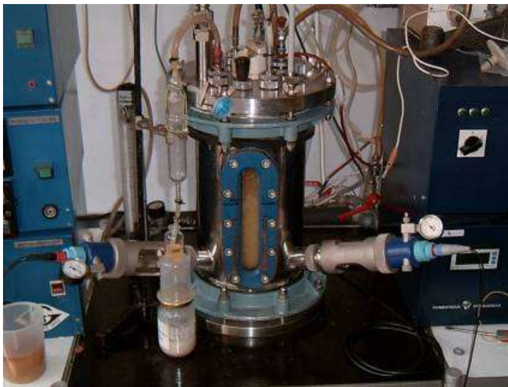
Slika 20: Mešalni bioreaktor z delovnim volumnom 10 L.
