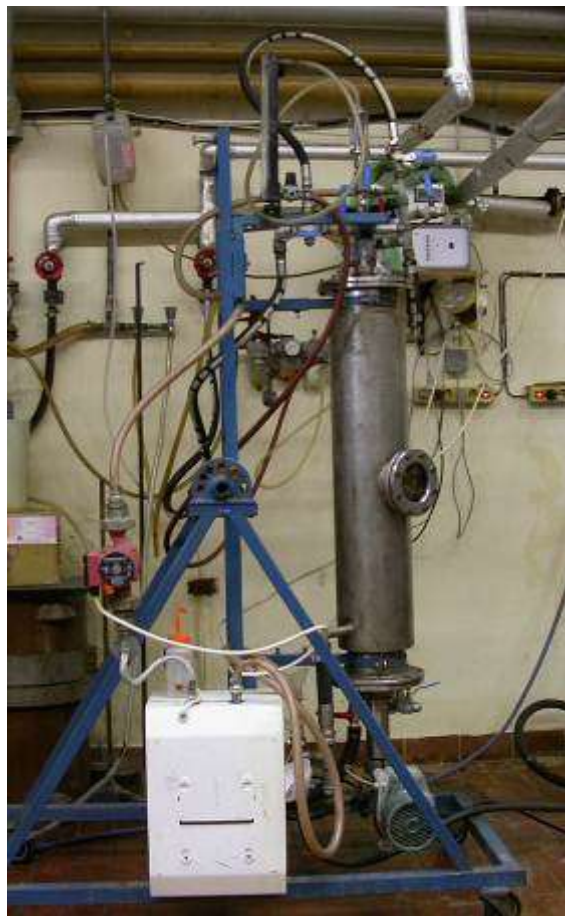
Slika 16: Pilotni mešalni bioreaktor - vertikalna pozicija.
