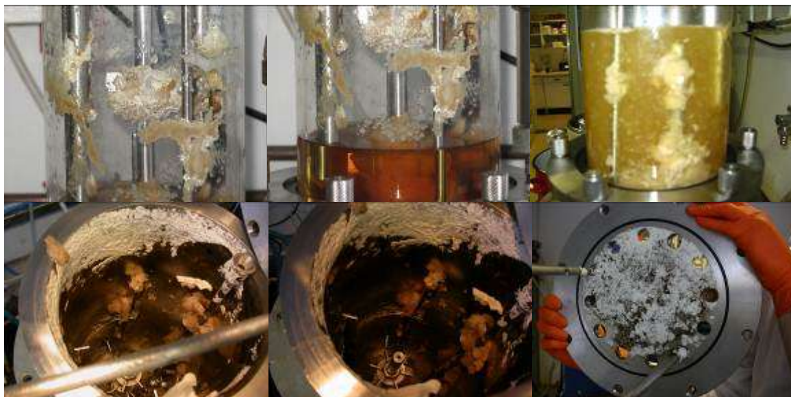
Slika 64: Rast micelija v tekočem gojišču v mešalnih bioreaktorjih.
