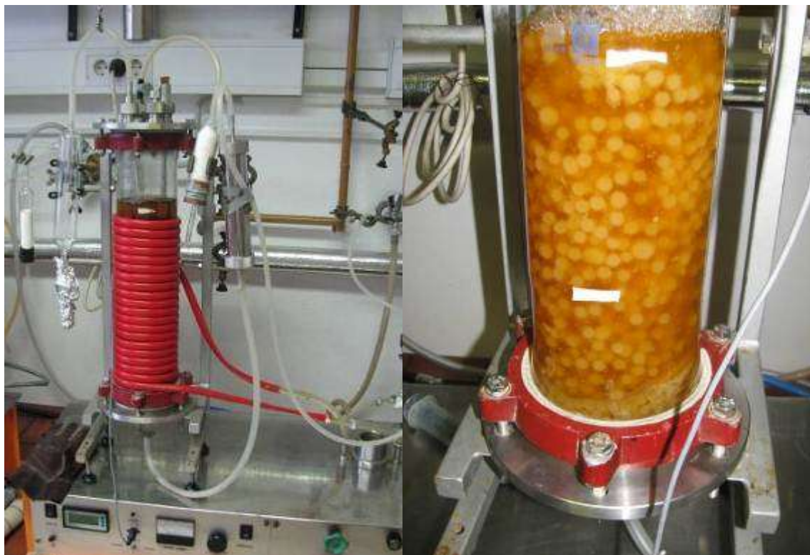
Slika 26 - 3.x+15: Bioreaktor za gojenje v tekočem gojišču - kolona z mehurčki.
