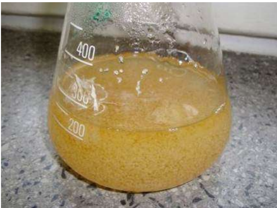
Slika 22: Prva varianta vcepka za uporabo v mešalnih bioreaktorjih (vcepek v obliki peletov).
