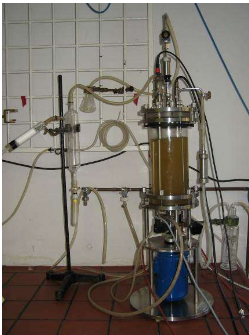
Slika 18: Mešalni bioreaktor Bioengineering KLF z delovnim volumnom 2 L.
