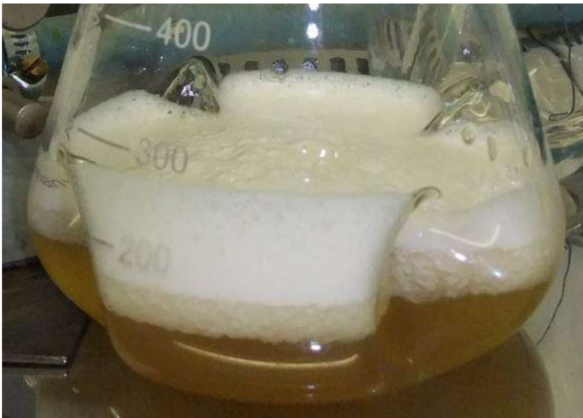
Slika 23: Druga varianta vcepka za uporabo v mešalnih bioreaktorjih (zmlet vcepek).
